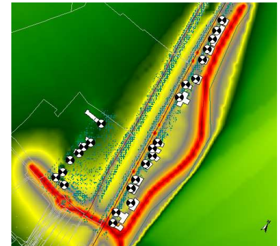
Figure 49 : logiciel CADNAA : exemple d'une carte d'isophones indiquant la propagation sonore d'un projet de déviation d'une infrastructure routière
